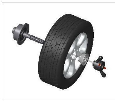
Вал станка - Колесо - Конус (вершиной внутрь) - Быстросъемная гайка
